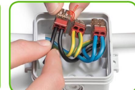
拆线操作: 通过左右转动连接器即可将导线拔出
